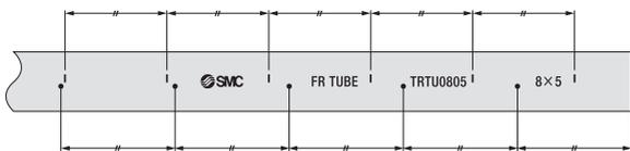
A camada externa, o filme laminado de alumínio e a camada externa são cortados na marca "i".
