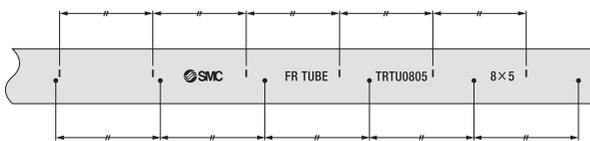
Indicação de espaçamento (Série KR-W2): Todos os comprimentos da instalação com o mesmo espaçamento
