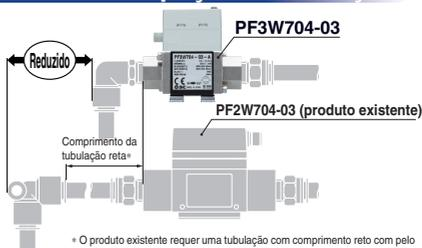
\* O produto existente requer uma tubulação com comprimento reto com pelo menos 8 vezes o diâmetro da tubulação. Consulte a precisão e o comprimento reto da tubulação. (Páginas 1046 e 1054)
