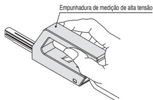
Nota) Use uma empunhadura de medição de alta tensão em situações como a medição de alta tensão, quando existir a possibilidade de o pessoal entrar em contato com a eletricidade.
