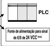
Nota) Quando a conformidade com a UL for necessária, o atuador elétrico e o driver devem ser usados com a fonte de alimentação UL1310 Classe 2.
