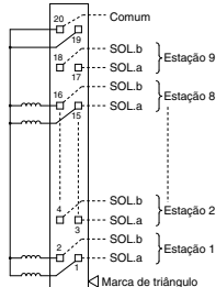
Tipo de cabo de fita plana 10PG/16PG (20 pinos)
